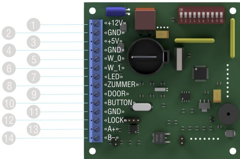
Рисунок 3 – Внешний вид управляющей платы
