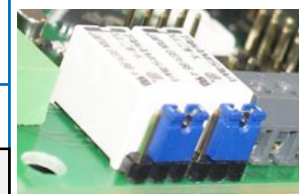
Контакты реле PAS нормально замкнуты
